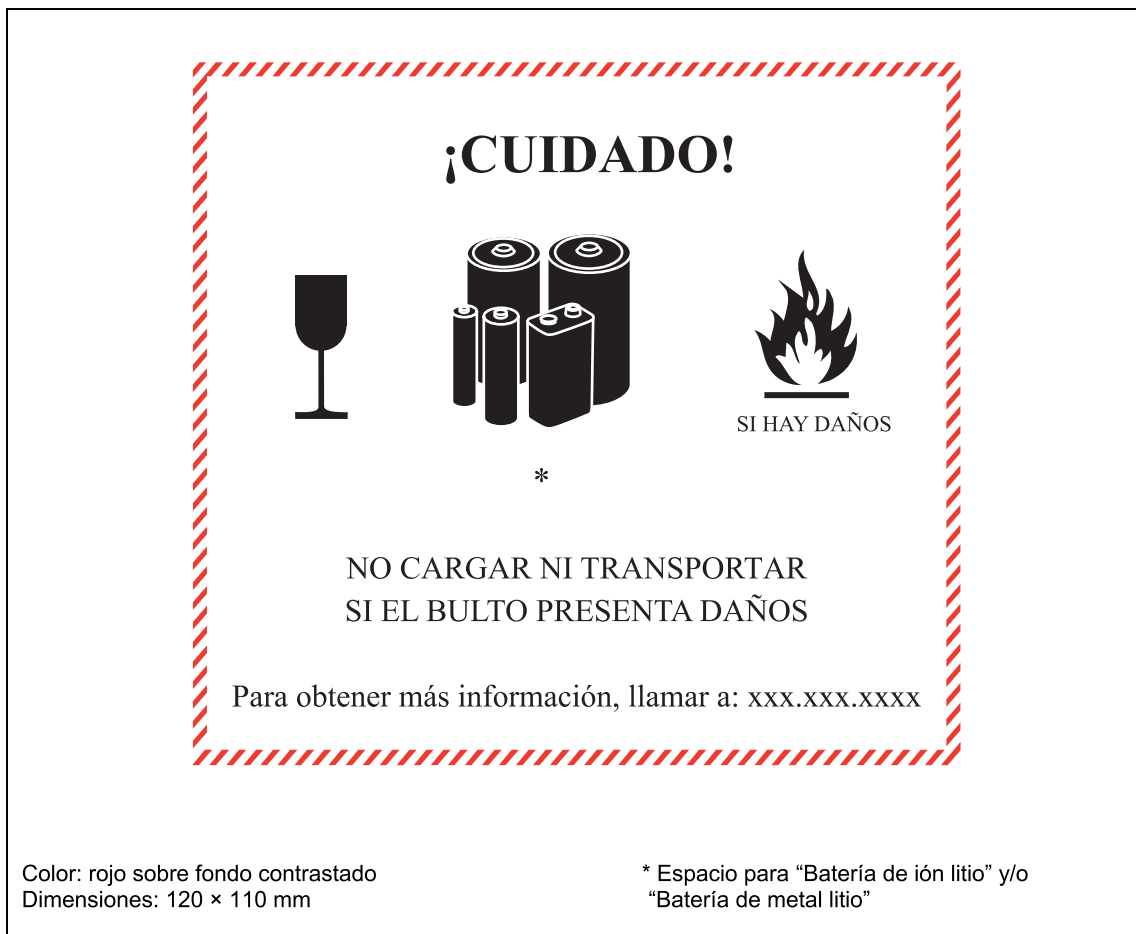
Figura 5-31. Etiqueta de manipulación de baterías de litio
